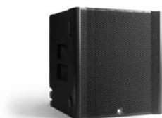
aktives, elektronisch steuerbares, Hochtonmodul mit Fohhn Two Beam Technologie (zwei unabhängige Abstrahlbeams) und Fohhn Side Lobe Free Technologie (Unterdrückung von Seitenabstrahlkeulen). 16 x 250 W Class-D DSP Endstufen mit 8x 1" und 8x1,4" Kompressionstreiber.
