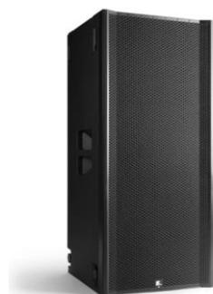
aktives, elektronisch steuerbares, Low-Mid Modul mit Fohhn Two Beam Technologie (zwei unabhängige Abstrahlbeams) und Fohhn Side Lobe Free Technologie (Unterdrückung von Seitenabstrahlkeulen). 4 x 1000 W Class-D DSP Endstufen mit 8 x 10" Langhub-Chassis
