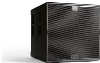
leistungsstarker 18"-Subwoofer. 18" Langhub-Chassis mit 4" Schwingspule. Belastbarkeit von 1000 W, Maximaler Schalldruck: 136 dB. Untere Grenzfrequenz 33 Hz
